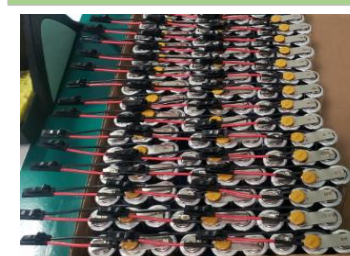
SUB00035 Sub ensamble con arnés soldado Battery pack 3B
